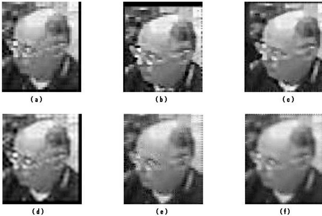
FIGURE 5. (a) : Une des images BR originales, (b) : Image obtenue avec la méthode MAP 1 ère version (décimation = 2, nombre d'images = 16), (c) : Image obtenue avec la méthode MAP 2 ème version (décimation = 2, nombre d'images = 16), (d) : Image obtenue par interpolation d'une image BR (décimation = 2, nombre d'images = 16), (e) : Image obtenue avec la méthode POCS (décimation = 2, nombre d'images = 16) et (f) : Image obtenue avec la méthode POCS (décimation = 4, nombre d'images = 16) (Source : Site de P. Milanfar).
