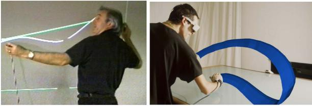
Figure 5: Exemples de dispositifs pour l'interaction dans les airs. (a) TapeDrawing, (b) Surface Drawing
