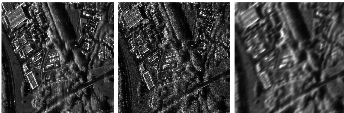
FIGURE 4.10 – De gauche à droite : image SAR 100-vues (quasiment sans bruit), image bruitée 1-vue, image débruitée, avec la même approche que celle décrite en section 3.4.2, en sélectionnant pour chaque patch l'atome qui lui correspond le mieux au sens du \text{SSD}_{\text{map}}^{\text{AI+SI}} avec le dictionnaire appris par l'approche proposée en figure 4.7.
