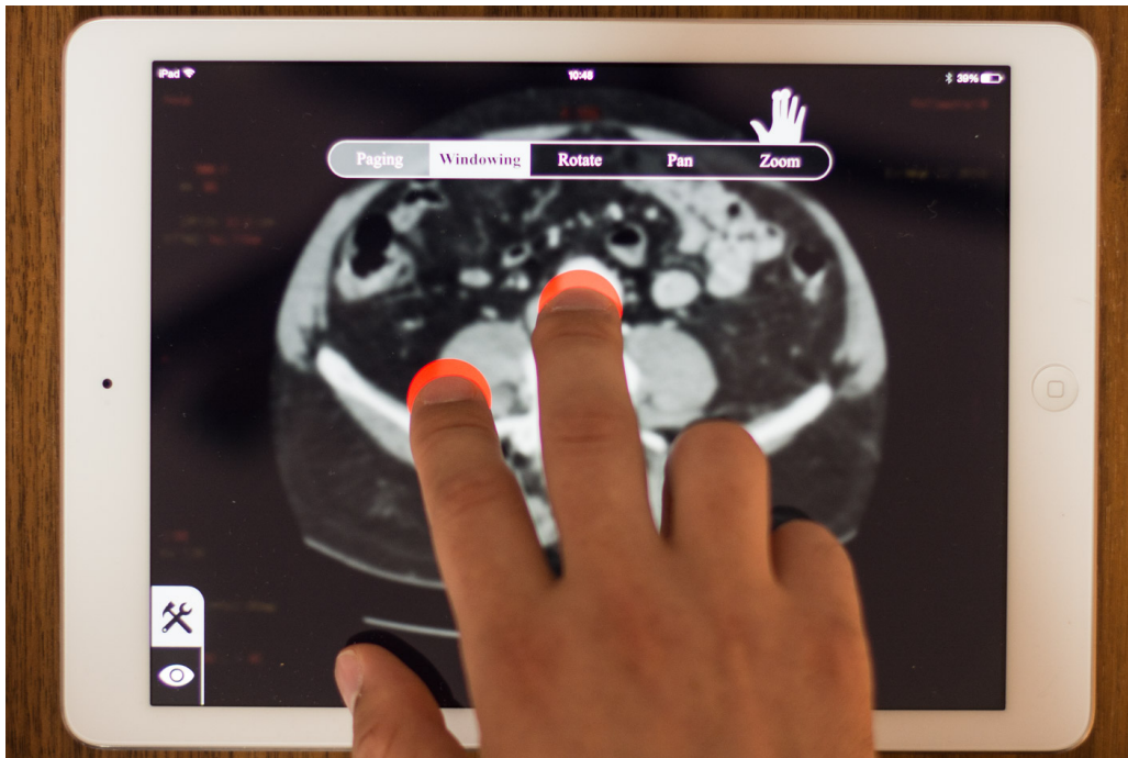
Figure 5.9 – Barre de Menus Multitouch . La barre de menu est affichée en bas à gauche. Le menu s'ouvre dans la partie supérieure de l'écran.
