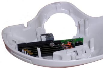
Figure 2 : la cellule Braille à l'intérieur du TactiBall
