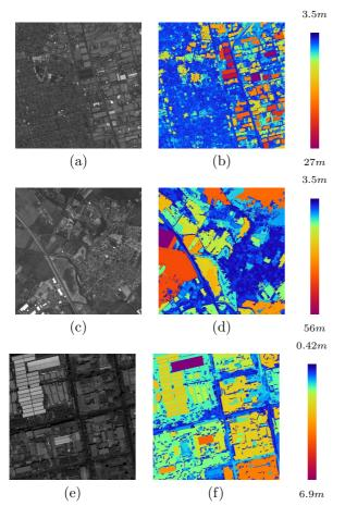
FIG. 3 – (a) Image de Los Angeles, SPOT5 (5m)©CNES; (b) Image d'échelle calculée à partir de l'image (a); (c) Image de Toulouse, SPOT5 (5m)©CNES; (d) Image d'échelle calculée à partir de l'image (c); (e) Image d'Ouagadougou, QuickBird (0.61m); (f) Image d'échelle calculée à partir de l'image (e), les formes dont les surfaces sont inférieures que 16 pixels ne sont pas prise en compte.
