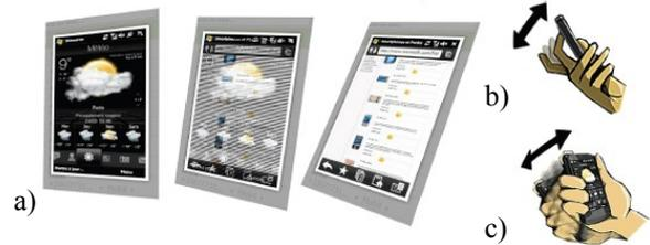
Figure 16 : a) Gestes fluides pour l'effet lenticulaire, b) Tap derrière le dispositif, c) geste impulsif
