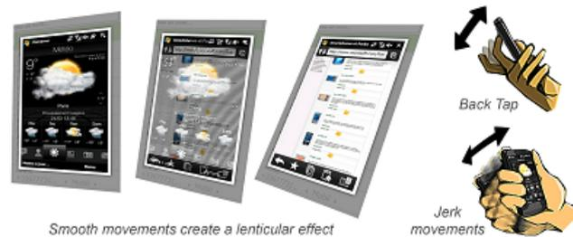
FIGURE 7.13 – TimeTilt (Roudaut *et al.*, 2009a) détecte l'inclinaison du téléphone pour basculer d'une application à l'autre.
