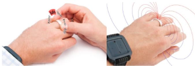
FIGURE 8.5 – L'anneau interactif Nenya. L'interaction se fait grâce à l'aimant situé sur l'anneau, et dont les mouvements sont captés par un magnétomètre dans le bracelet.
