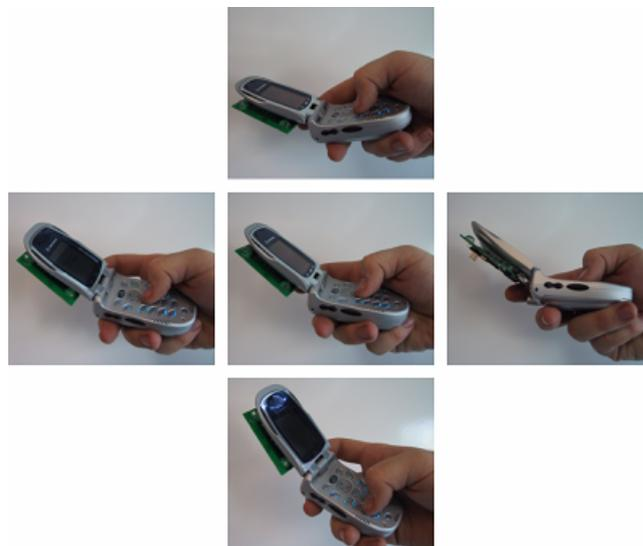
FIGURE 7.11 – Dans Tilttext (Wigdor and Balakrishnan, 2003), en appuyant sur une des touches du clavier l'utilisateur peut soit entrer un chiffre (position neutre), soit entrer une des lettres affichées sur la touche (inclinaison vers le haut, bas, gauche ou droite). L'inclinaison est détectée avec un accéléromètre.
